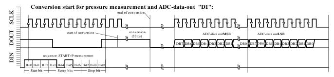
Fig. 6a: D1 ACQUISITION sequence
